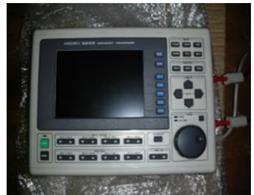
写真 268-1 測定に用いたメモリーハイコーダ HIOKI 製 形式 8835
