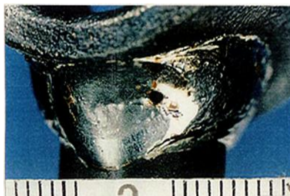
写真140-01 丸棒とパイプのT字すみ肉全周溶接におけるビードラップ部に吹き出したブローの外観例
