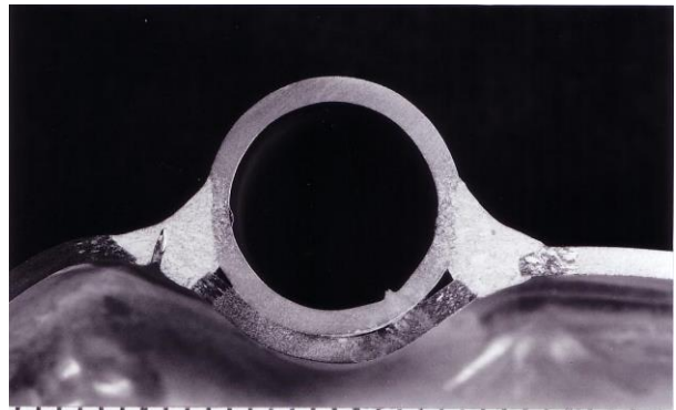
写真134-04c マグ短絡溶接・クレータ部裏側ビードより進展した収縮孔事例
