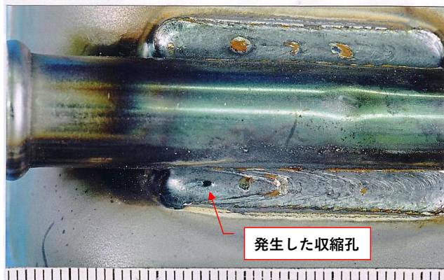
写真134-04a マグ短絡移行溶接・クレータ部収縮孔
