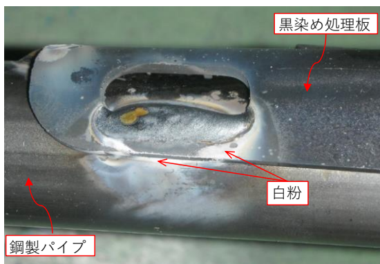
写真127-01 (b) シートフレームのパイプと黒染め処理 ブラケットのCO2溶接 ⇒ 溶接部周辺にZnOによる白粉発生
