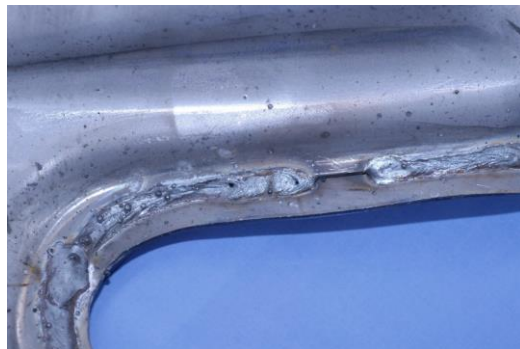
写真120-02 1.8-2.3t 亜鉛メッキ鋼板同士の重ねすみ肉マグ溶接 (ブローホール多い、スパッター多発)
