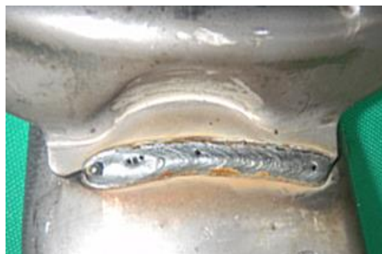
写真120-01 2.0-2.0t亜鉛メッキ鋼板同士の重ねすみ肉マグ溶接（ブローホール発生）
